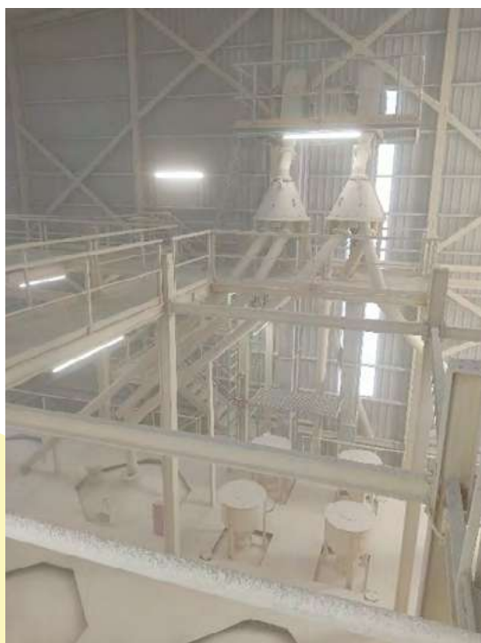
Instalaciones de filtración y ejemplo de instalación sin captación de polvo.
