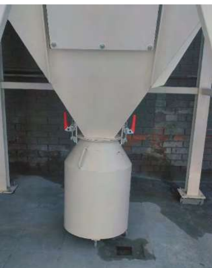
Distintos tipos de descargas (izquierda tolvín manual, derecha rotoválvula).
