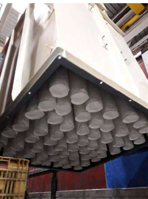
Cuerpo de filtro de mangas con mangas colgando en su interior.
